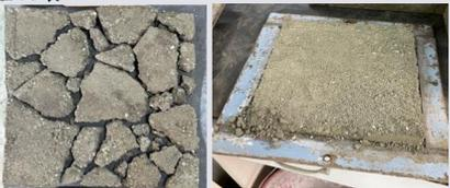
焚化底渣100%高壓混凝土地磚(水灰比0.5)
