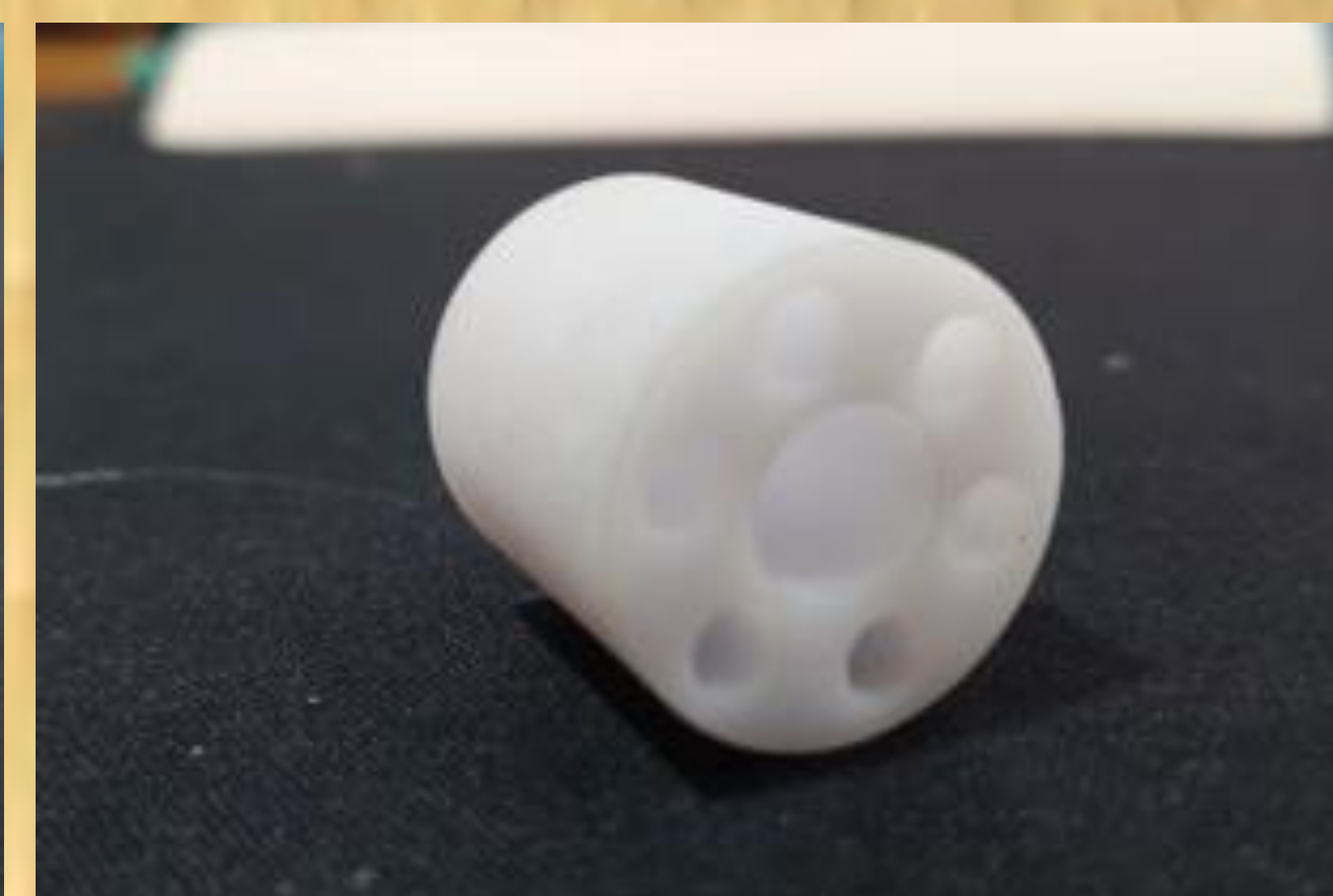
圖(b):SLA製程零件
