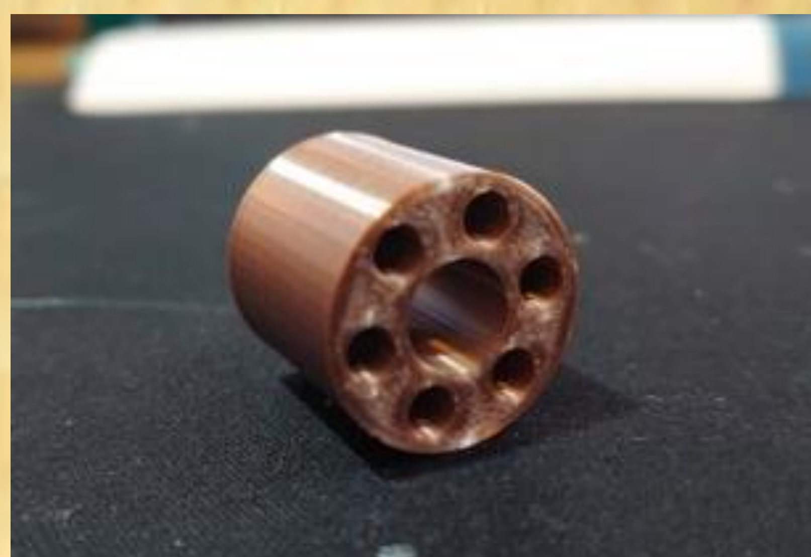
圖(a):FDM製程零件
