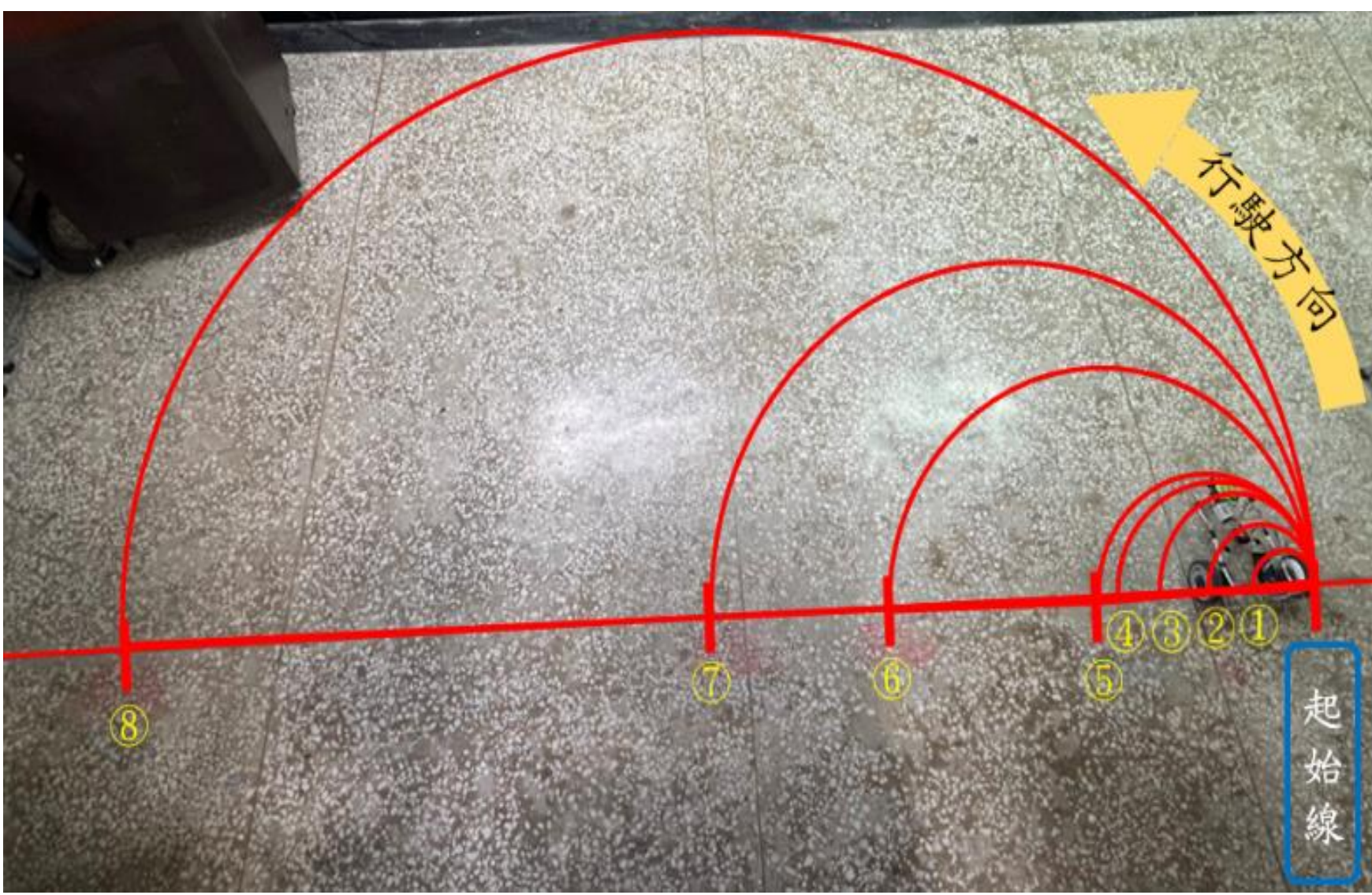
圖二、PWM各差值之左轉彎路徑圖及轉彎直徑一覽表
