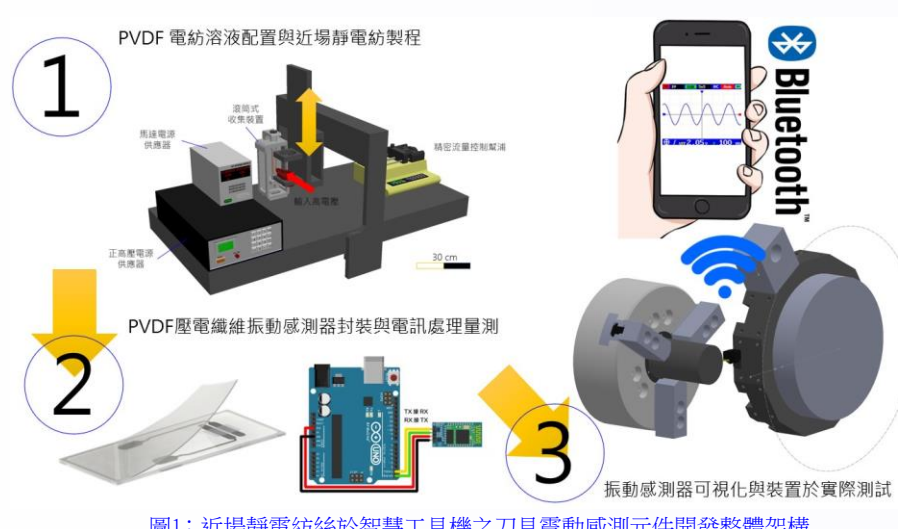
圖1：近場靜電紡絲於智慧工具機之刀具震動感測元件開發整體架構
