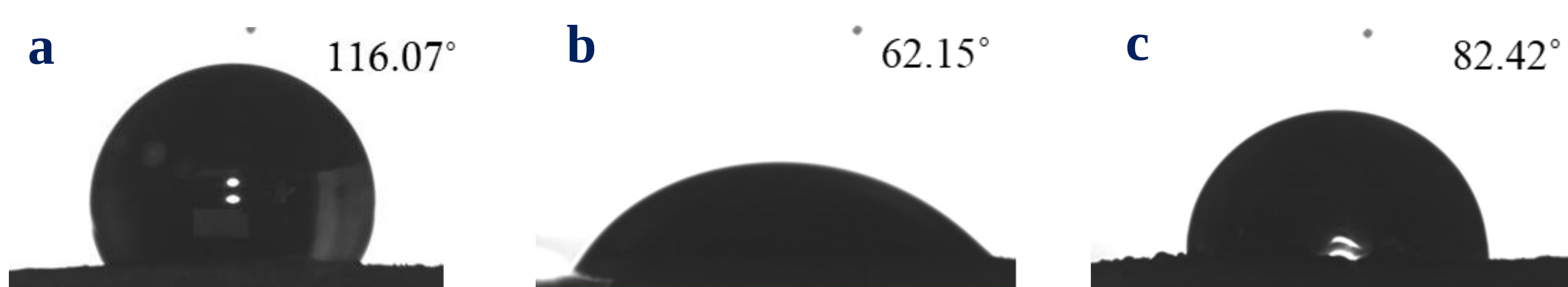
BP試片(a)未旋鍍(b)旋鍍TA(c)旋鍍PSS改質劑後之接觸角
